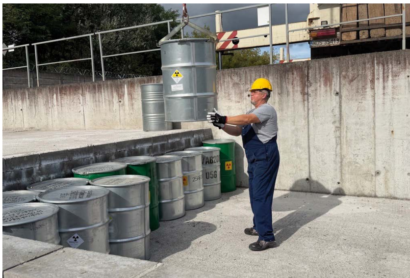
Krajowe Składowisko Odpadów Promieniotwórczych w Różanie: widok z lotu ptaka (u góry) i pracownik przy składowaniu bębnow z zabezpieczonymi odpadami promieniotwórczymi (u dołu)
